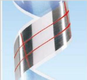
불연속성 구간을 가지는 Metal Foil을 Twist Pair Cable에 감싸 보호층을 형성하면, 인접한 케이블로부터 발생하는 전자결합이 불연속성 Metal Foil로 인해 효과적으로 감쇠되어 Alien Crosstalk가 감소
